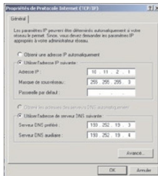
Écran 4. La définition de l'adresse IP et du masque de sous-réseau de la carte Allied de la machine CPGE ▶
