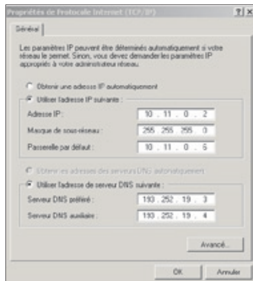
Écran 2. La définition de l'adresse IP et du masque de sous-réseau de la carte 3Com de la machine CPGE ▶
